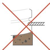
Manque de support du tuyau engendre une contrainte excessive sur le raccord et la paroi du réservoir.
