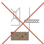
Manque de support du tuyau engendre une contrainte excessive sur le raccord et la paroi de la citerne.
