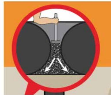
5. Ensuite, remplissez les espaces/passages de sable stabilisé. Faites le remblayage/compactage toujours à la main
